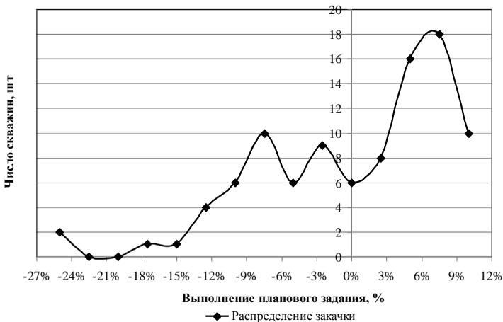
**Рис. 4.14.** Кривая распределения поскважинного выполнения планового задания при  $Q_{пл} = 20,49$  тыс.м<sup>3</sup>/сут: «-» — недозакачка, «+» — перекачка
