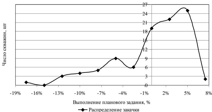
**Рис. 4.18.** Кривая распределения поскважинного выполнения планового задания при  $Q_{пл} = 23,37$  тыс.м<sup>3</sup>/сут: «-» — недозакачка, «+» — перезакачка
