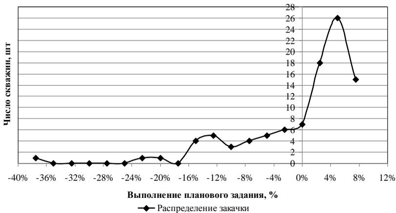
**Рис. 4.4.** Кривая распределения поскважинного выполнения планового задания при  $V_{пл} = 17,41$  тыс.м<sup>3</sup>/сут: «-» — недозакачка, «+» перекачка
