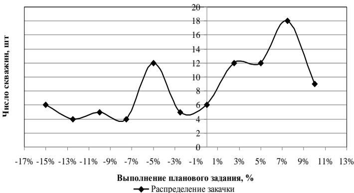
**Рис. 4.15.** Кривая распределения поскважинного выполнения планового задания при  $Q_{пл} = 20,92$  тыс.м<sup>3</sup>/сут: «-» — недозакачка, «+» — перекачка
