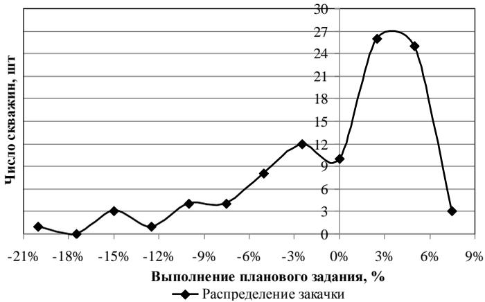
**Рис. 4.16.** Кривая распределения поскважинного выполнения планового задания при  $Q_{пл} = 22,82$  тыс.м<sup>3</sup>/сут: «-» — недозакачка, «+» — перекачка
