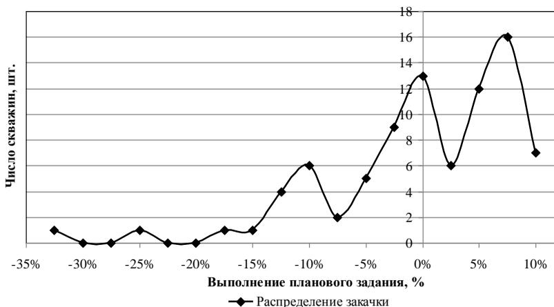
**Рис. 4.9.** Кривая распределения поскважинного выполнения планового задания при  $V_{пл} = 13,80$  тыс.м<sup>3</sup>/сут: «-» — недокачка, «+» — перекачка
