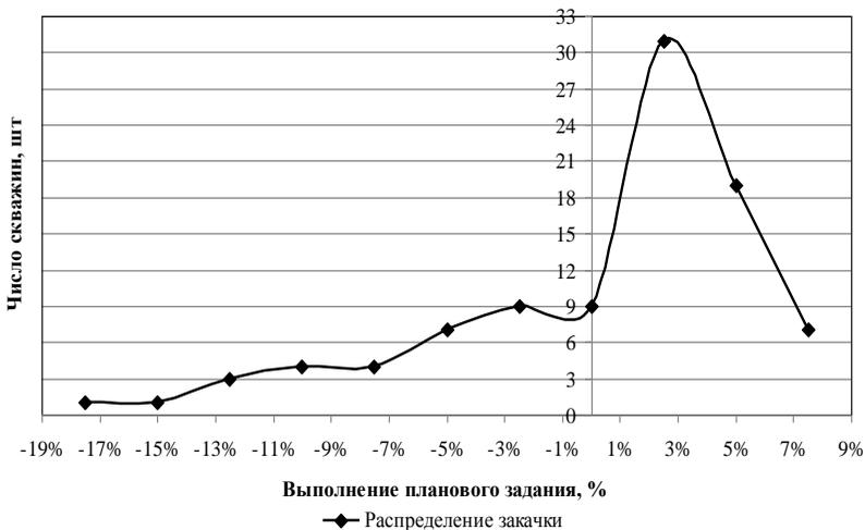
**Рис. 4.12.** Кривая распределения поскважинного выполнения планового задания при  $Q_{пл} = 18,26$  тыс.м<sup>3</sup>/сут: «-» — недозакачка, «+» — перекачка
