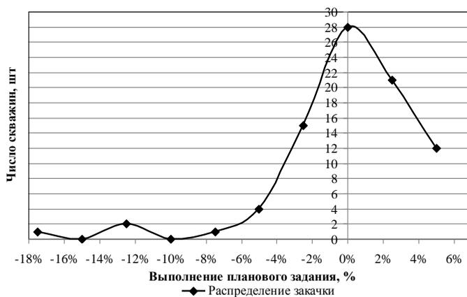
**Рис. 4.2.** Кривая распределения поскважинного выполнения планового задания при  $V_{пл} = 13,80$  тыс.м<sup>3</sup>/сут: «-» — недозакачка, «+» — перекачка
