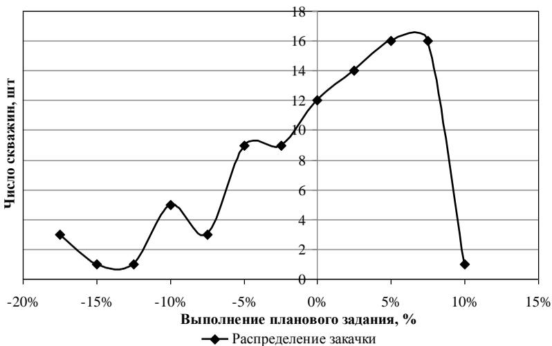
**Рис. 4.10.** Кривая распределения поскважинного выполнения планового задания при  $Q_{пл} = 15,40$  тыс.м<sup>3</sup>/сут: «-» — недозакачка, «+» — перекачка
