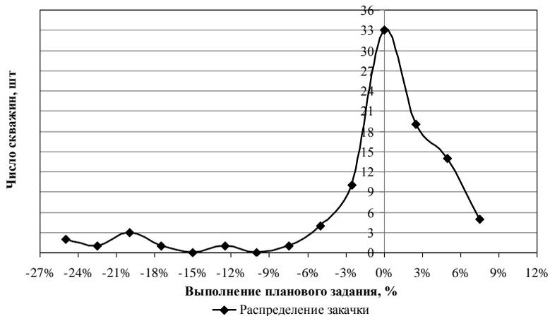
**Рис. 4.17.** Кривая распределения поскважинного выполнения планового задания при  $Q_{пл} = 23,19$  тыс.м<sup>3</sup>/сут: «-» — недозакачка, «+» — перекачка
